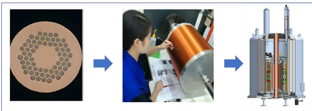
高性能低温超导线材是核磁共振波谱仪超导磁体建造的基础
